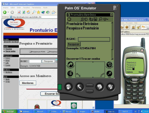
Figura 4 - O protótipo em funcionamento. À esquerda, vê-se uma página do Prontuário Eletrônico original. No centro e à esquerda, vê-se telas convertidas para novos formatos ( XHTML para PDA e WAP para celular).
